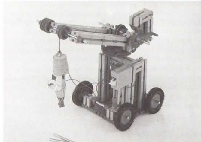
Abb. 13.7 Vier umwickelte Nagel dienen als Elektromagnet
