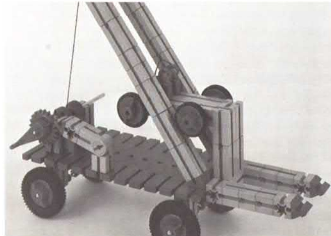
Abb. 8.8 Vier Räder lagern die Gabel am schrägen Standmast
