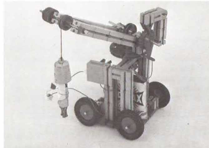
Abb. 13.8 Durch eine Drehscheibe kann der Ausleger geschwenkt werden
