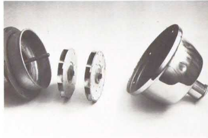
Abb. 11.14 Zweistufiges Staubsaugergebläse (Radiallüfter)
