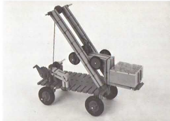
Abb. 8.7 Gabelstapler mit Sperrvorrichtung hebt eine Last
